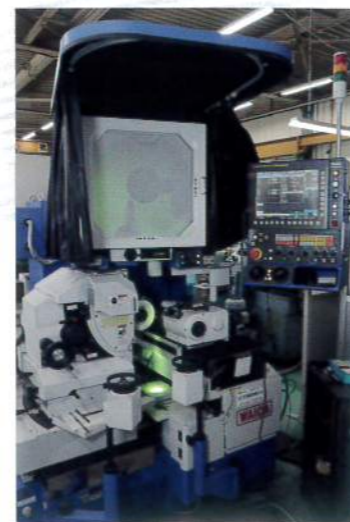
和井田製作所製プロフィール研削盤
