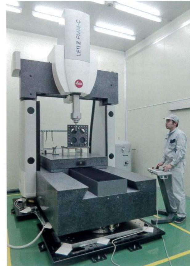
Leitz社製高精度三次元測定機 (検査3号室) 自社製ホールプレート (アーティファクト)
